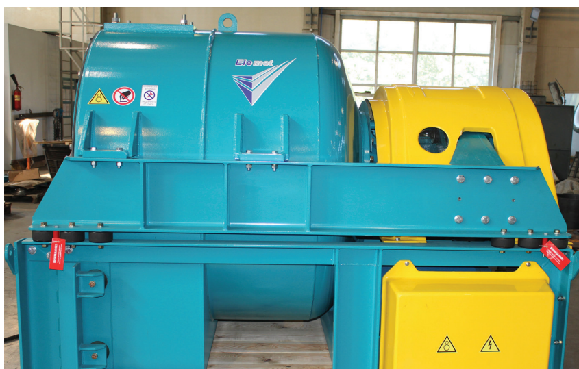
Фильтрующая центрифуга с вибрационной разгрузкой для обезвоживания продуктов обогащения угля крупностью от 0,15 до 50 мм
