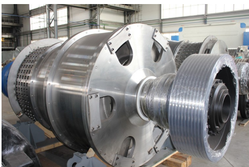
Ротор для осадительно-фильтрующей центрифуги производства «ЭЛЕМЕТ»
