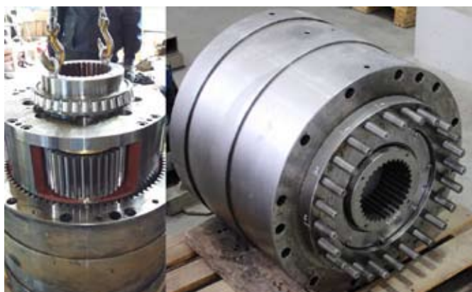
Сборка планетарного редуктора ОФЦ «Элемет»
